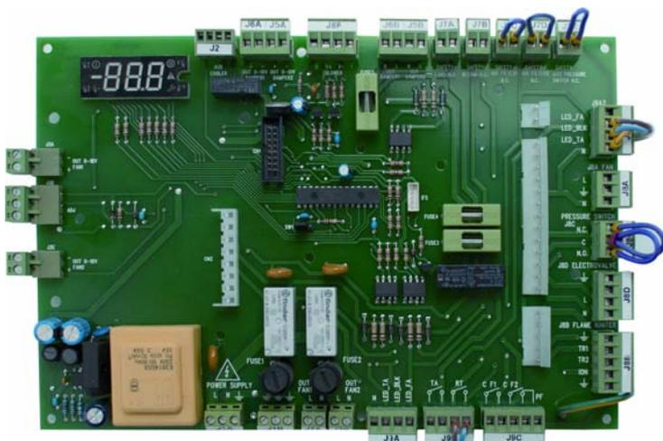
La platine de commande électronique à microprocesseur et mémoire EEPROM est véritablement « l'âme » du générateur et inclus les éléments de base suivants :
