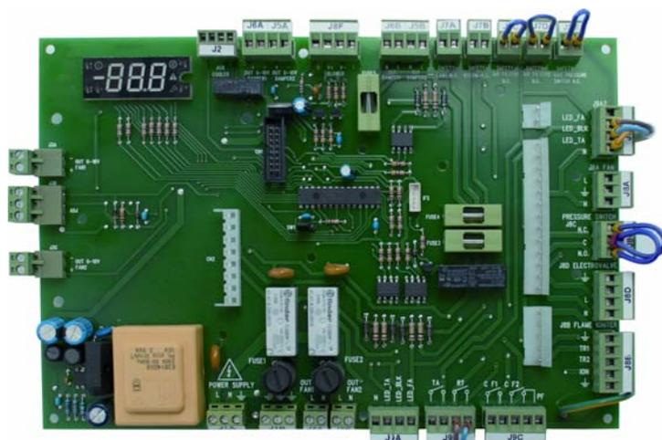
La platine de commande électronique à microprocesseur et mémoire EEPROM est véritablement « l'âme » de l'aérotherme et inclus les éléments de base suivants :
